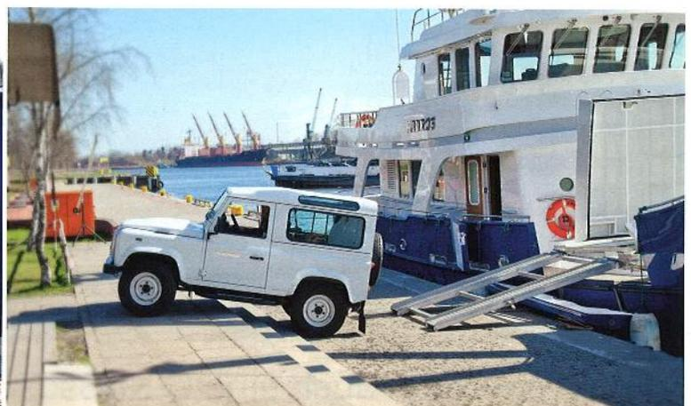
Sobald die Rampe auf dem Kai aufliegt, wird der Defender hydraulisch in Position gefahren und kann die Yacht verlassen.
