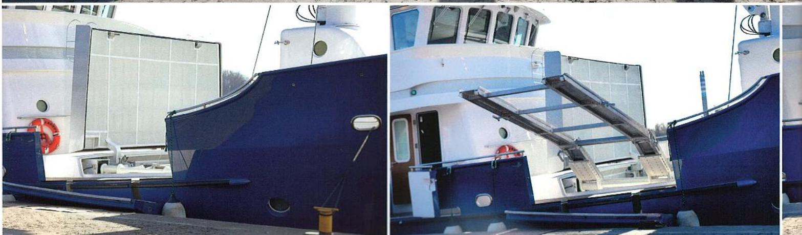
„Anlegemanöver“ des Defenders: Als Erstes öffnet sich die Klappe der Garage; das Schanzkleid und die Rampe klappen herunter.
